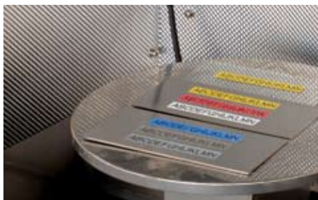
Résistance à la décoloration : après avoir subi l'équivalent d'une année d'exposition au soleil dans une chambre de décoloration, le texte des étiquettes laminées reste intact.
