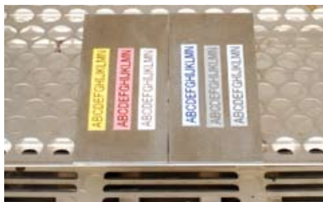
Résistance aux températures : après 240 heures d'exposition à des températures comprises entre -80° C et +150° C, le texte des étiquettes laminées reste intact.
