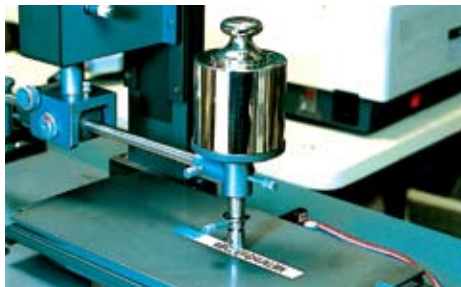
Résistance aux abrasions : après 50 passages d'une ponceuse d'1 kg, le texte des étiquettes laminées reste intact.
